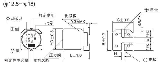
● φ8×10L, φ10×10L, φ12.5×13.5L, φ16×16.5L, φ18×16.5L 能够制造抗振结构品。
