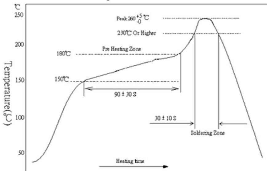
備註：零件最高耐溫 $260 +5/-0 ^\circ\text{C}$ ，10秒。
