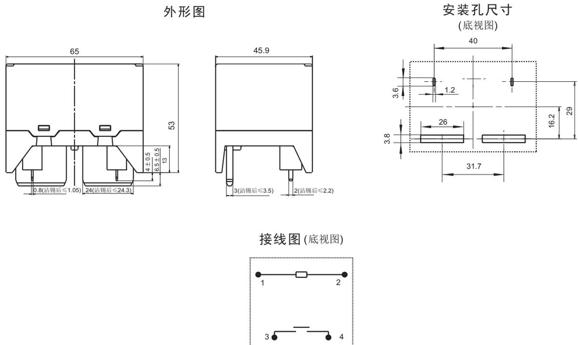
备注: (1) 产品部分外形尺寸未注尺寸公差, 当外形尺寸 $\leq 1\text{mm}$ , 公差为 $\pm 0.2\text{mm}$ ; 当外形尺寸在 $(1 \sim 5)\text{mm}$ 之间时, 公差为 $\pm 0.3\text{mm}$ ; 当外形尺寸 $> 5\text{mm}$ , 公差为 $\pm 0.4\text{mm}$ ;
